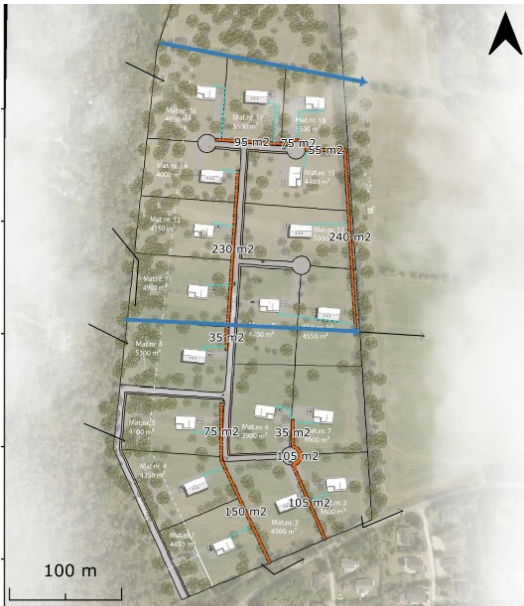
Figur 9.1: Vandhåndteringsplan, samt arealudlæg for grøfter for Mejsemarken. /13/ Veje og bygninger efter situationsplan (bilag 3)
